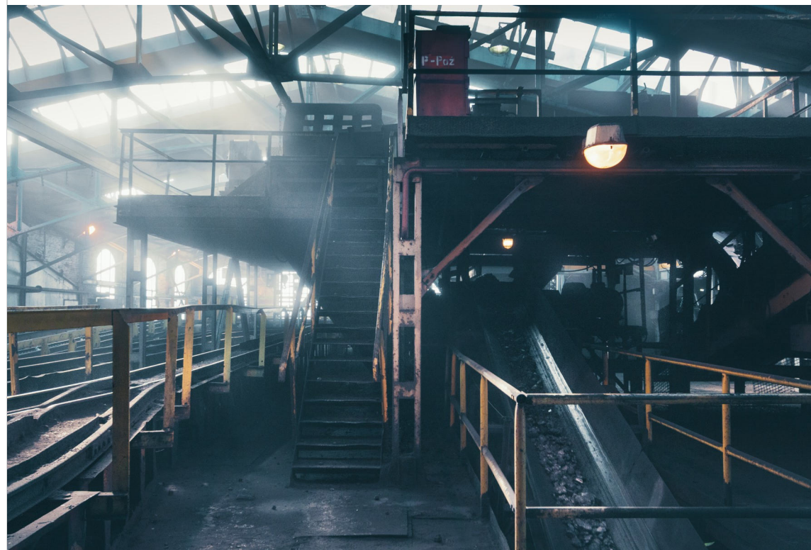
Hala obiegu wozów i taśmociąg transportujący węgiel po wydobyciu na wyższą kondygnację do płuczki. Przestrzeń hali nadszybia płynnie łączą się z zakładem przeróbczym w kompleksie zabudowań szybu „Pułaski”.
