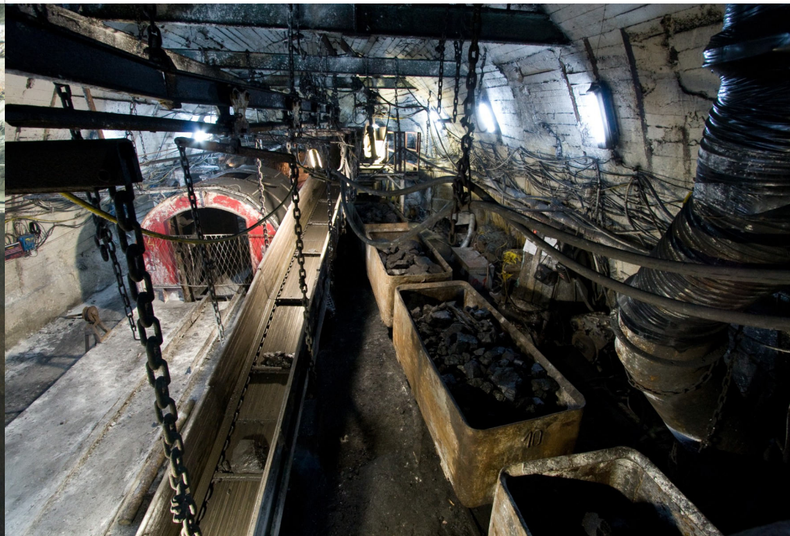
Ładowanie przesortowanego węgla przenośnikiem zgrzebtowym na wozy kolejki podziemnej. Poziom 550 m, szybk 10. przy szybie „Roździeński”.
